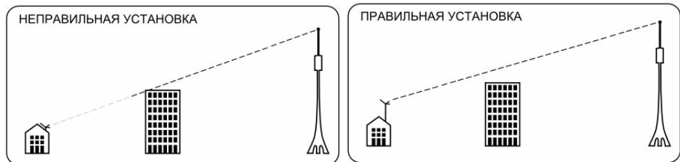
При работе в зоне неуверенного приема качество изображения не гарантируется. При установке антенны необходимо выбрать правильный угол по направлению к станции вещания. Для приема сигналов горизонтальной поляризации антенну следует располагать горизонтально, а для вертикальной, соответственно, вертикально.
