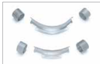
Рис. 8-3 Фиксаторы поворота (водоснабжение) (3-4 x \varnothing ) – 90° или 45° для изгиба труб \varnothing 16-32
