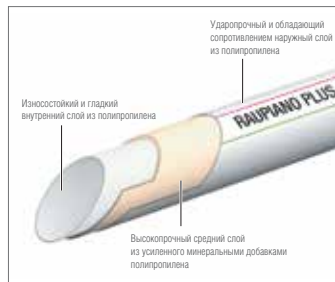
Рис. 18-1 Конструкция трубы RAUPIANO PLUS
