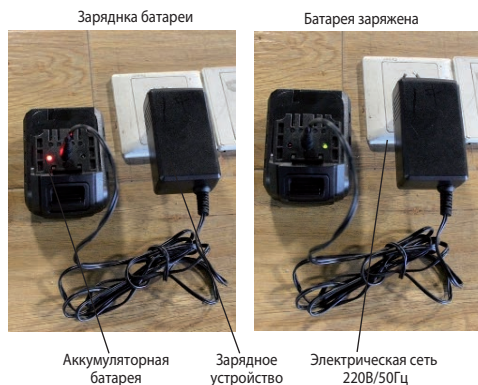
Рис. 2. Зарядка аккумуляторной батареи
