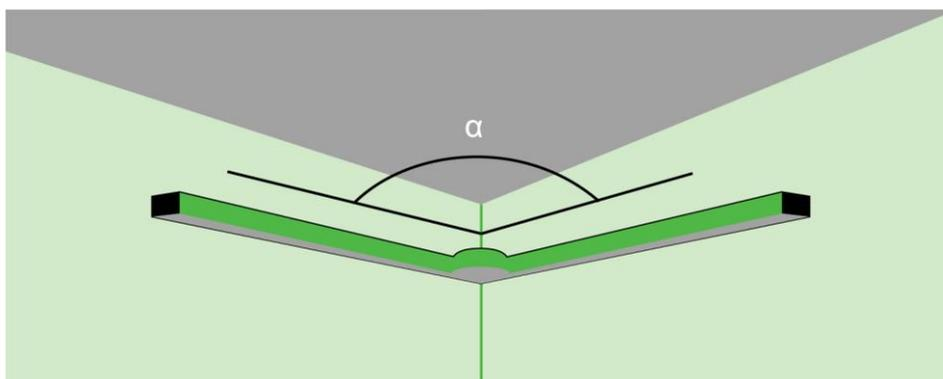
При углах не равных 90 градусов, используйте торцовочную пилу. Пильный диск должен иметь максимальное число зубьев (диск для резки алюминия). Выставьте необходимый угол и произведите запил. Если угол в помещении равен 90 градусов - для запила можно использовать стусло и мелкозубую ножовку.
