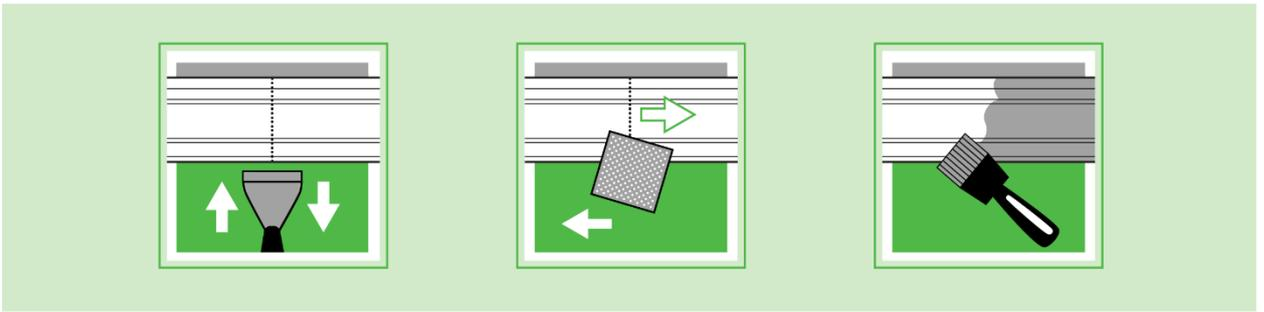
Шаг 1 - Зашпатлевать обработанные стыки водорастворимой мелкодисперсионной шпатлевкой для внутренних работ, чтобы сгладить видимые стыки.
