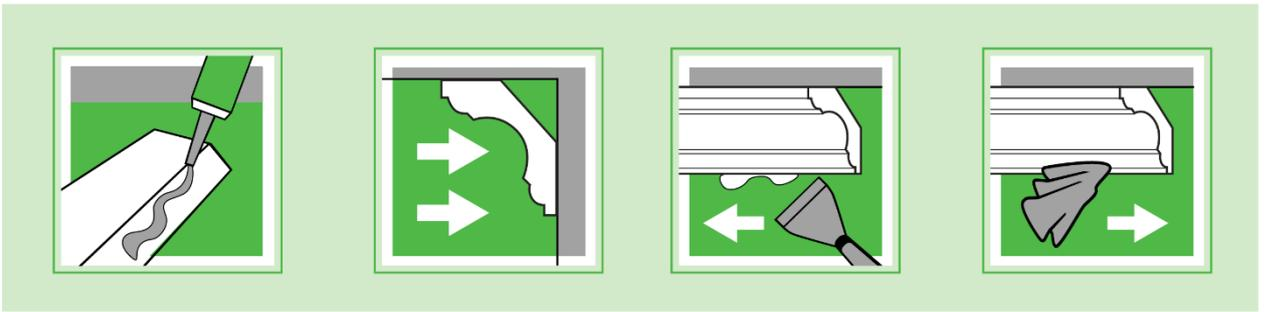
Шаг 1 - Равномерно нанести на монтажную поверхность (места примыкания изделия к стене) «Монтажный клей / Жидкие гвозди» по всей длине изделия. Толщина наносимого слоя клея 3-5мм.
