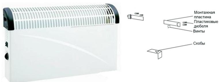
С помощью монтажного комплекта установите обогреватель на стене у пола. Расстояние между монтажными отверстиями на задней части обогревателя составляет 41,5 см. Глубина и диаметр монтажного отверстия соответственно 35 мм и 8 мм. Расстояние от прибора до пола должно быть не менее 10 см.
