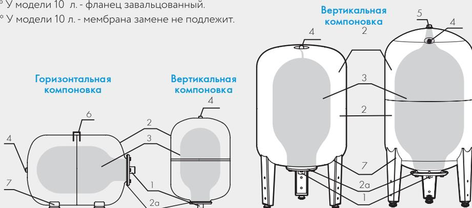
В исходном состоянии в гидроаккумулятор через воздушный клапан (ниппель) закачан воздух до давления 1,5 бар.
