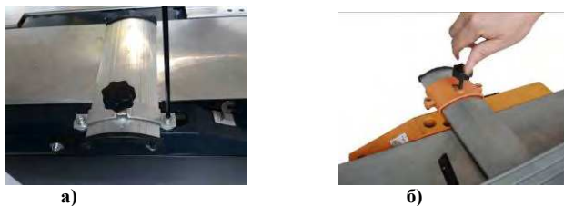
Рис.6 Установка защитного кожуха фрезы
