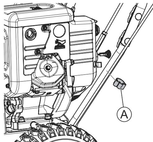
После установки верхней рукоятки закрепите трос привода шнека при помощи пластиковой клипсы (А)
