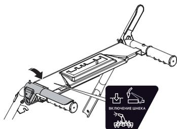
Нажмите на рычаг привода шнека по направлению к ручке управления, шнек начнет вращение и можно начинать расчистку снега. Для отключения шнека отпустите рычаг.
