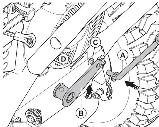
Установите на снегоуборочной машине в отверстие коннектора (B) тягу (A) и закрепите, используйте крепёжные элементы: (C) шайба - 1 шт.; (D) шплинт - 1 шт.
