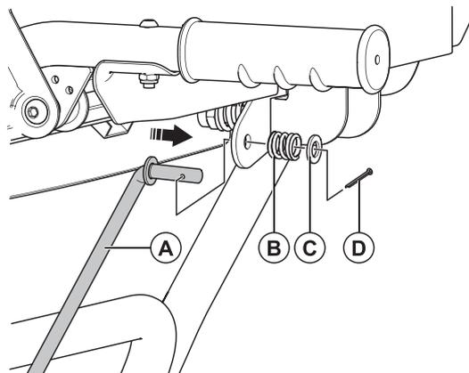
Установите на верхней рукоятке в приемное отверстие рычага переключения передач тягу (A), используйте крепёжные элементы: (B) пружина - 1 шт.; (C) стопорное кольцо - 1 шт.; (D) шплинт - 1 шт.
