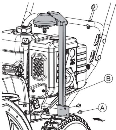
Установите поворотный механизм (B) на кронштейн снегоуборщика и закрепите при помощи болтов (A). Используйте крепёжные элементы: (A) болт M8x16 – 2 шт.
