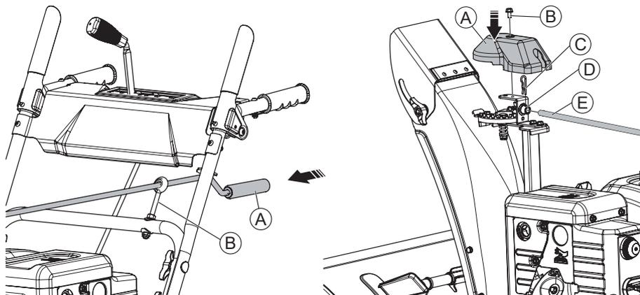
Проденьте рукоятку поворота желоба (А) через хомут (В) нижней рукоятки и установите её в отверстие рулевого механизма, зафиксируйте штифтом. Установите декоративную крышку (А) и зафиксируйте ее. Используйте крепеж: (В) болт М6×12 – 1 шт.; (С) шплинт – 1 шт.
