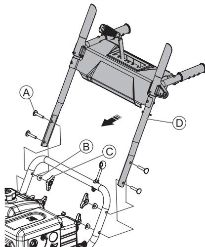
Совместите отверстия нижней и верхней рукояток, и закрепите при помощи болтов и пластиковых барашковых гаек. Используйте крепёжные элементы: (А) болт М8х50 – 4шт.; (В) фигурная шайба – 4 шт.; (С) барашковая гайка М8 - 3 шт. Затяните болты от руки. Закрепите трос привода шнеков.
