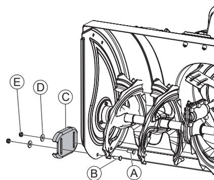
Для предохранения от повреждений частей ковша снегоуборочной машины установите башмаки по его обеим сторонам. Используйте детали крепежа: (А) болт М8×25 – 2 шт.; (В) болт М8×20 – 2 шт.; (D) гроверная шайба D8 – 4 шт.; (E) Гайка М8 – 4 шт.
