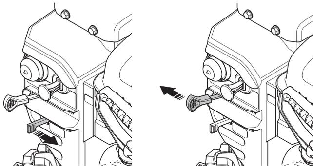
**Примечание!** Для повторного запуска горячего двигателя возможно оставить рычаг воздушной заслонки в положении **«ОТКРЫТО»**.
