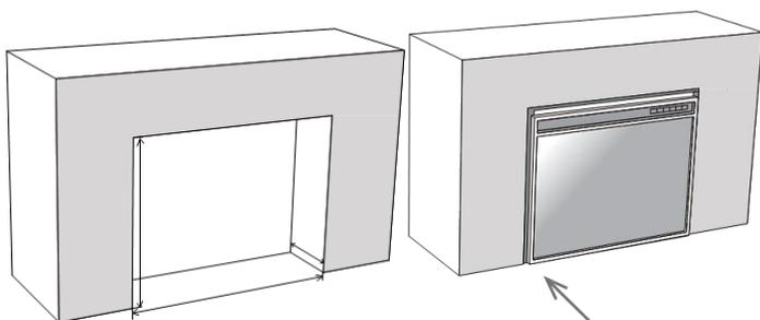
Размеры отверстия: В 508mm x Ш 644mm x Г 160 mm
