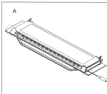
б. Снимите крепление и верхние накладки пластмассовой вентиляционной решетки
