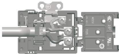
Для подключения к однофазной сети 220-240 В с заземлением: коричневый провод подсоединить к L, синий - к N, а провод заземления (желто-зеленый) – к (⊕)
