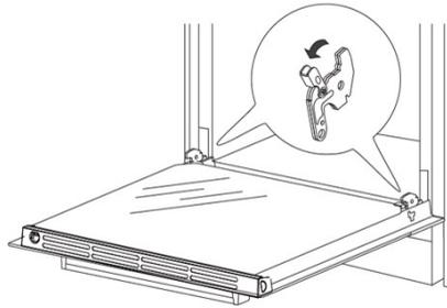
в. Осторожно закрывайте дверцу прибора, пока не услышите характерный звук сцепления. Придерживая дверцу обеими руками, прикройте её ещё немного и потяните вверх, чтобы извлечь болт петли из духового шкафа.
