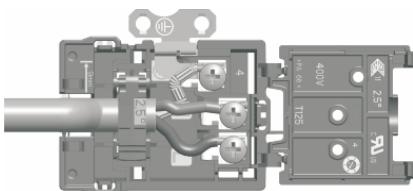
Осторожно! При любом подключении заземляющий провод подсоединяется к клемме защитного заземления
