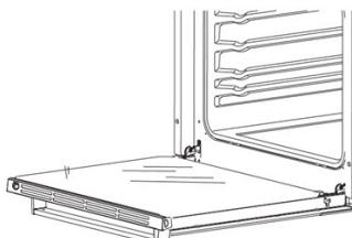
б. Откиньте фиксаторы
