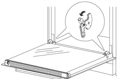
в. Осторожно закрывайте дверцу прибора, пока не услышите характерный звук сцепления. Придерживая дверцу обеими руками, прикройте её ещё немного и потяните вверх, чтобы извлечь болт петли из духового шкафа.
