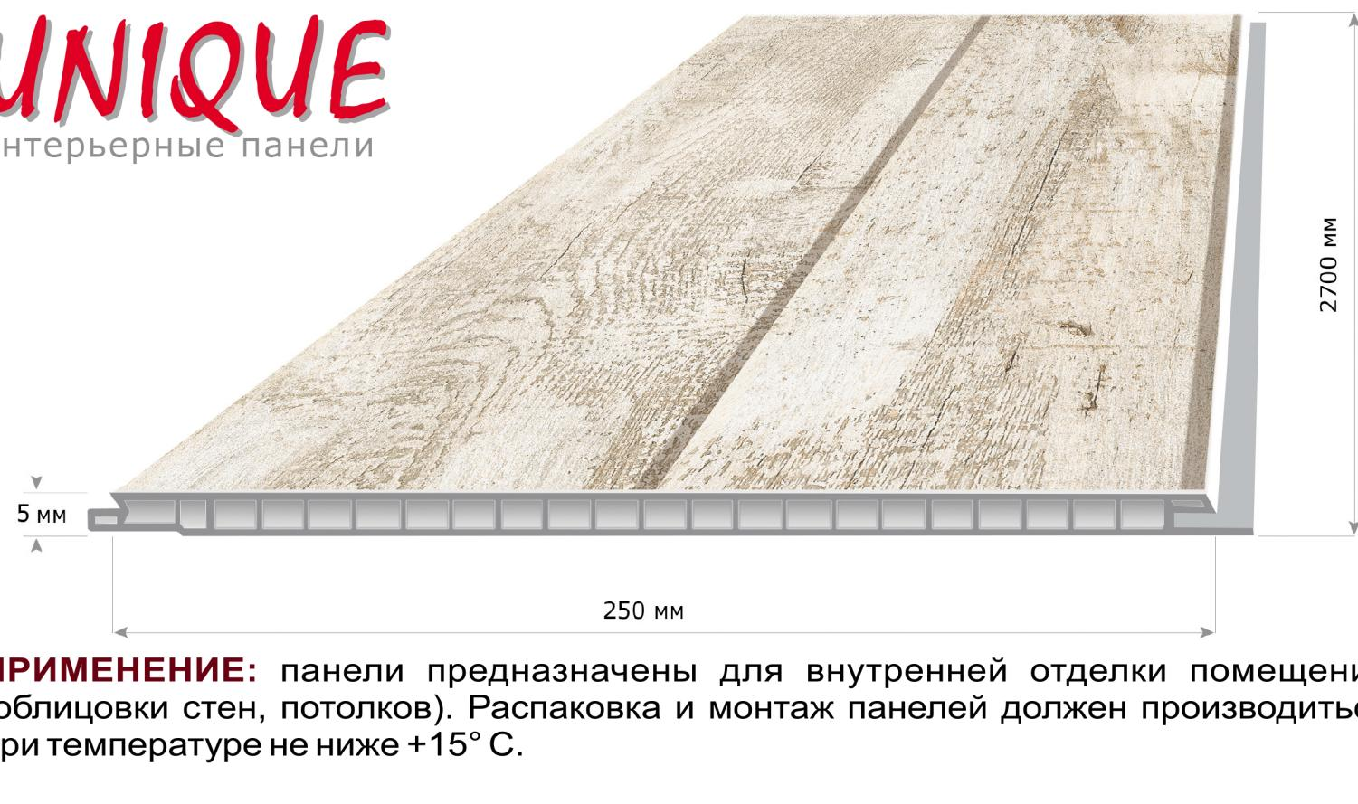
**ПРИМЕНЕНИЕ:** панели предназначены для внутренней отделки помещений (облицовки стен, потолков). Распаковка и монтаж панелей должен производиться при температуре не ниже +15° С.
