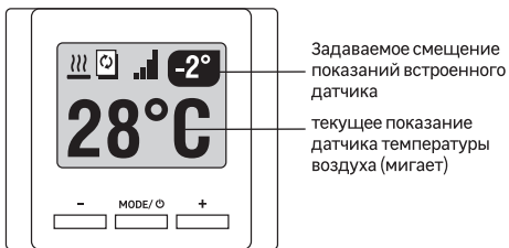
Рис. 7 Индикация в режиме корректировки показаний датчика температуры воздуха
