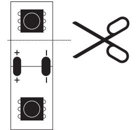
Ленты со 120 светодиодами на метр желательно разрезать выше места разреза, ближе к краю верхнего или нижнего светодиода (см. рис.). В противном случае светодиод будет закрыт корпусом коннектора.
