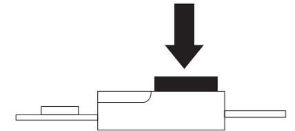
Надежность фиксации соединения обеспечивается полным прижимом крышки.
