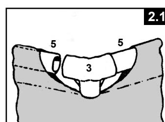
**ПРИМЕЧАНИЕ:** Важно начинать с одного места и работать в одном направлении до последнего крепления. Не начинайте с нескольких мест, так как это осложнит закрепление нескольких последних штанг и соединений.
