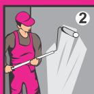
Обработайте основание грунтом БОЛАРС «Глубокого проникновения», сильно впитывающие поверхности загрунтуйте дважды.
